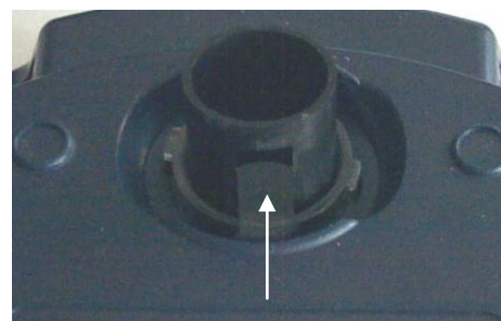
Fig 30 – Dépose de la gaine optique
