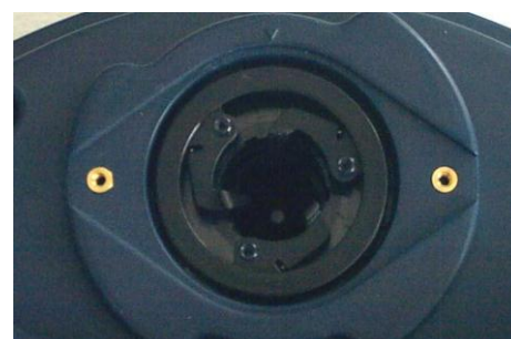
Fig 28 – Cloche d'accouplement et pignons droits
