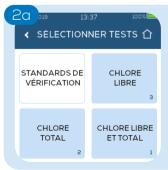
Pour sélectionner des types de test, appuyez sur les touches qui correspondent. Un nombre apparaîtra dans l'angle inférieur droit. Ce nombre représente l'ordre dans lequel ils apparaissent sur les écrans de sélection de test.
